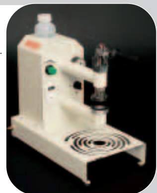
Postazione per il test della saldatura Seam testing station
